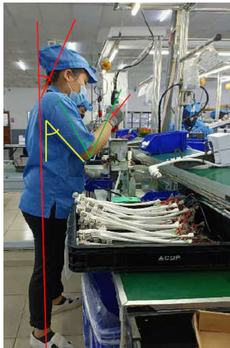
Gambar.2 operator memasang screw dengan mesin screw untuk menyatukan mold body ke support di atas meja Jig
