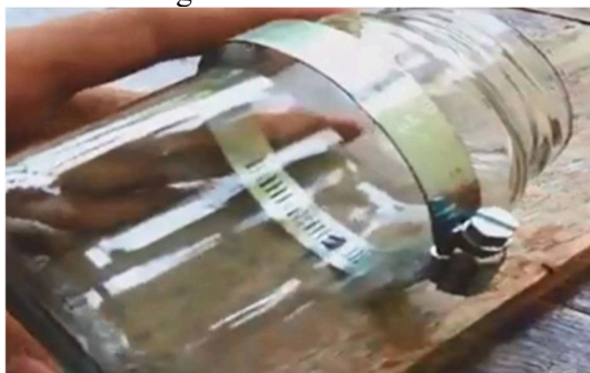
Gambar 8. Memasukkan toples kedalam klem ring
