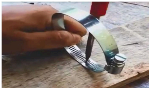
Gambar 7. Menguatkan klem ring ke permukaan kayu dengan baut
