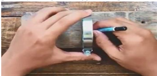
Gambar 5. Mengatur posisi klem ring
