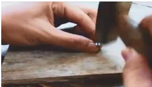
Gambar 6. Membolongkan untuk dudukan klem ring pada kayu
