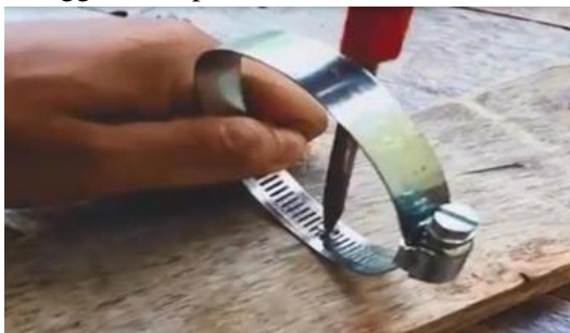
Gambar 7. Memperkuat klem ring ke permukaan kayu dengan baut
