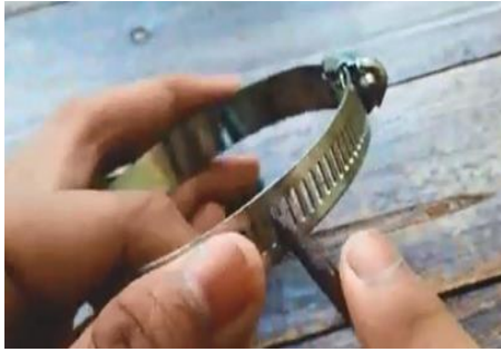
Gambar 4. Membolongkan klem ring
