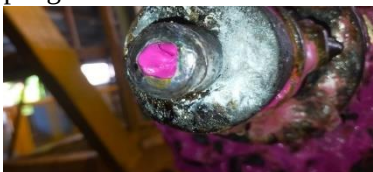
Gambar 6 Nozzle Mesin Yang Sudah Dimakan Usia
